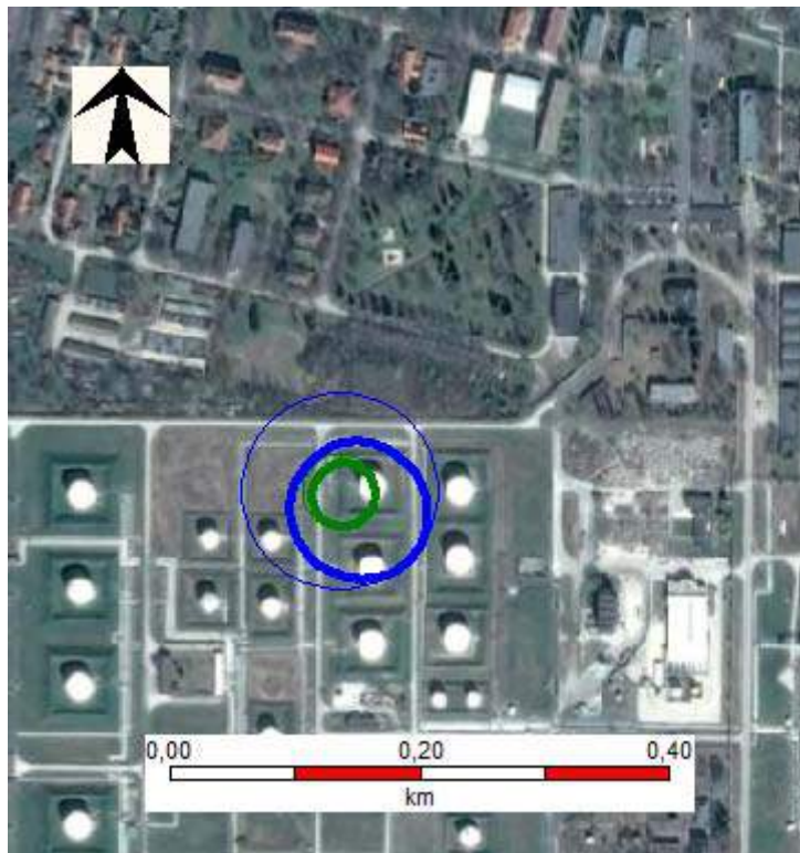
6.3.5.1.5.5. ábra A3 eseménysor – Kései tócsatűz - hőszugárzás
