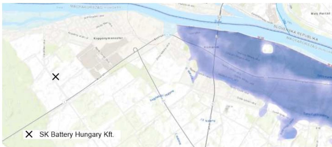
1 x 10 -2 árvíz előntési gyakoriságú terület Komáromban (kékekkel jelölt terület) - az SK Battery Hungary Kft. telephelyével
